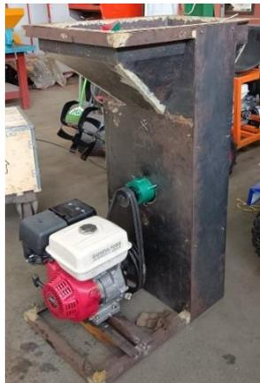
Gambar 19. Mesin Penggiling Sekam Padi
