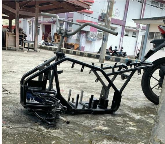
Gambar 10 Rangka ATV Listrik
