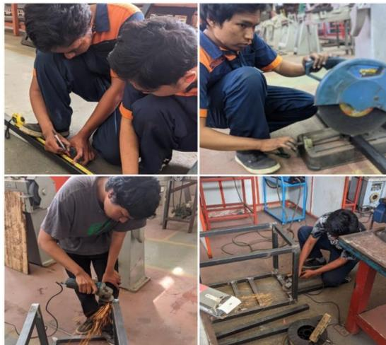
**Gambar 22.** Proses Pembuatan Rangka
