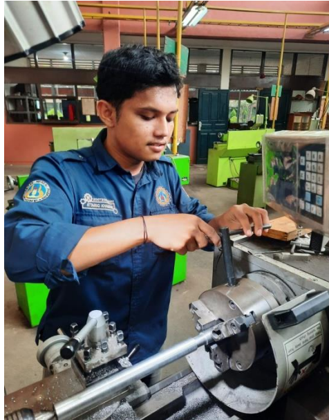
Gambar 30. Pemasangan Mata Potong Center Drill
