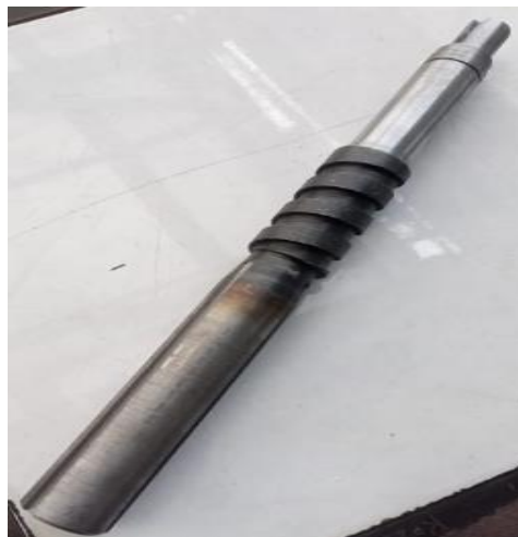
Gambar 23. Poros Mesin Penggiling Padi
