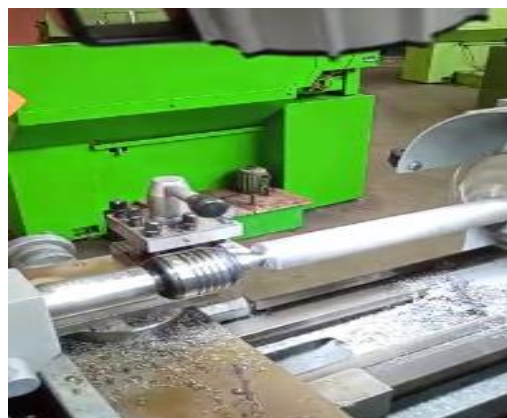
Gambar 29. Proses Bubut Permukaan
