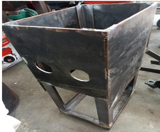
Gambar 2.2 Rangka pemecah tempurung (Sumber : Adril meikal, 2023)
