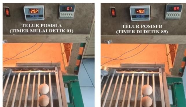
Gambar 21. Pergerakan Rak Telur Posisi A ke Posisi B
