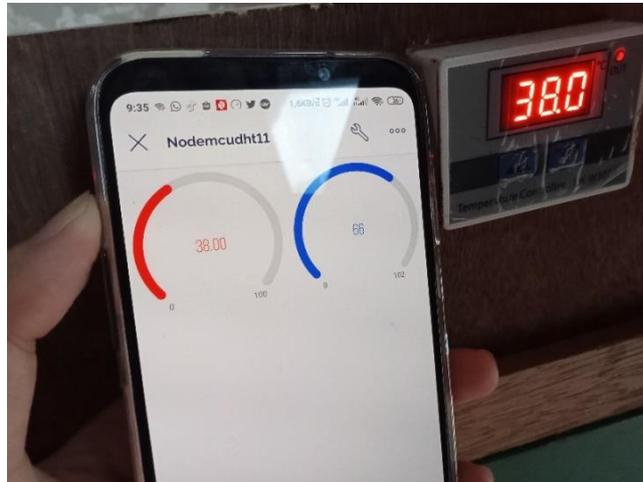
Gambar 20. Sinkronisasi thermostat digital dengan DHT 11
