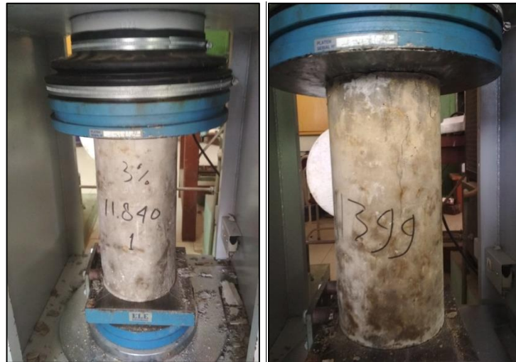
Gambar 20. Pengujian Kuat Tekan Beton
