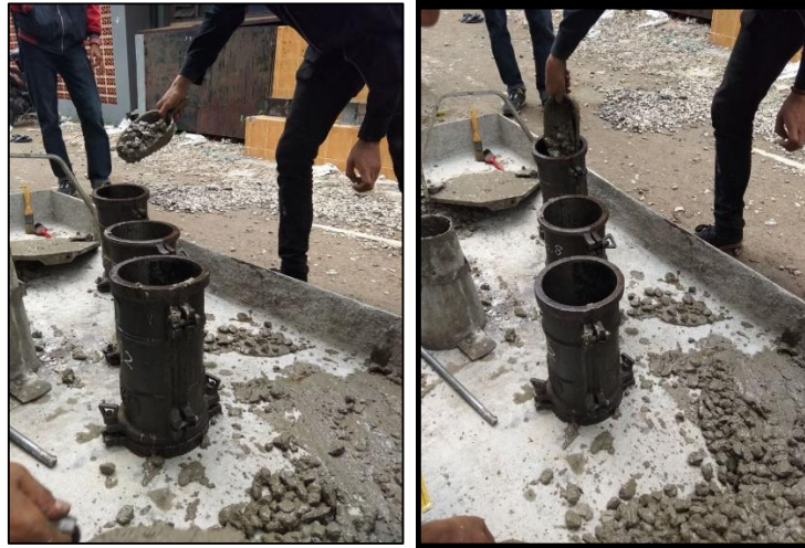
Gambar 13. Penuangan Campuran Beton Dalam Cetakan
