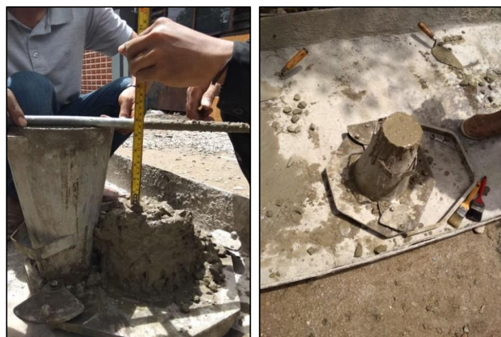
Gambar 12. Pengujian Slump Sampel Beton
