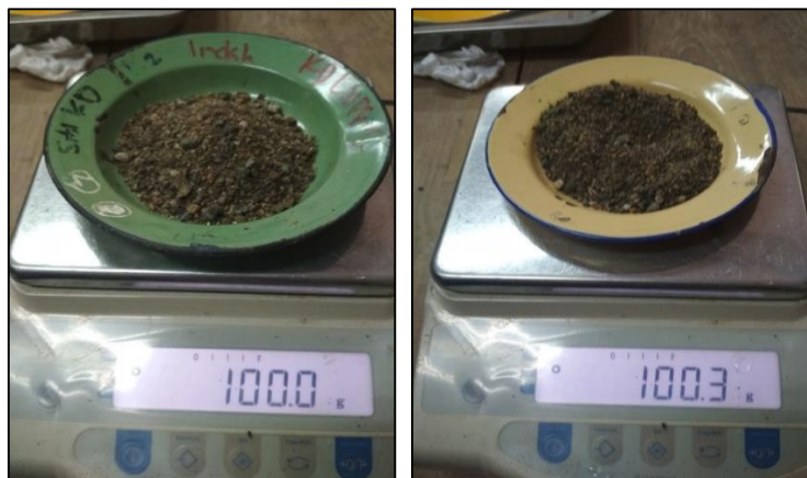
Gambar 2. Penimbangan Agregat Halus
