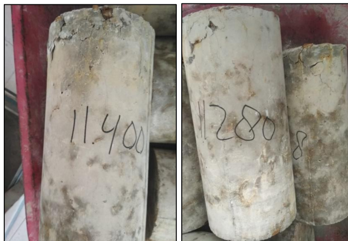
Gambar 21. Retakan Sampel Beton Setelah Pengujian Kuat Tekan Beton
