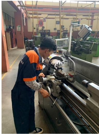
Gambar 4.2. Proses Pemotongan dan memperkecil ukuran as Besi menggunakan mesin bubut
