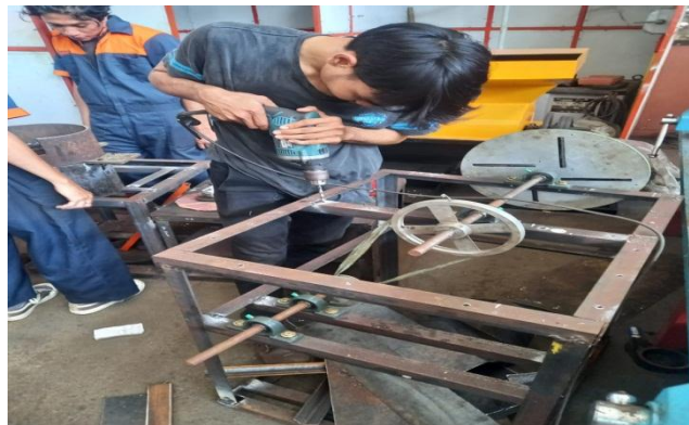
Gambar 3.8 Proses pengeboran (Laboratorium Fabrikasi UNP)
