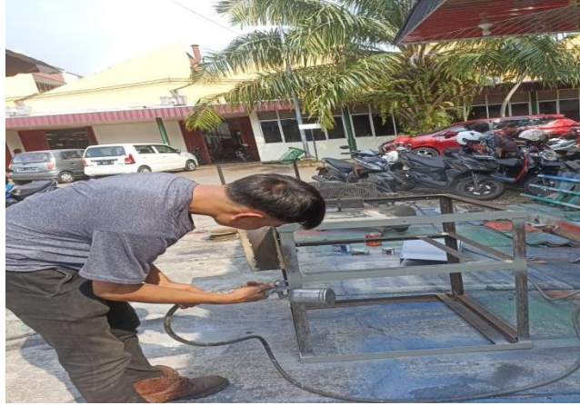
Gambar 3.9 Proses pengecatan rangka (Laboratorium Fabrikasi UNP)
