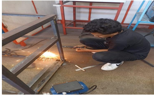
Gambar 3.7 Tahap pengelasan penuh (Laboratorium Fabrikasi UNP)
