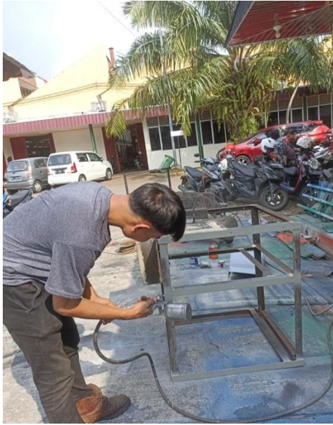
Proses pengecatan rangka
