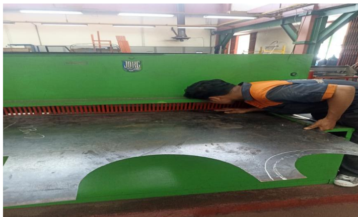
Gambar 3.10 Pemotongan plat (Laboratorium Fabrikasi UNP)
