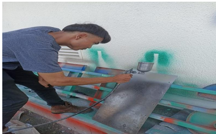
Gambar 3.12 Proses pengecatan bodi (Laboratorium Fabrikasi UNP)
