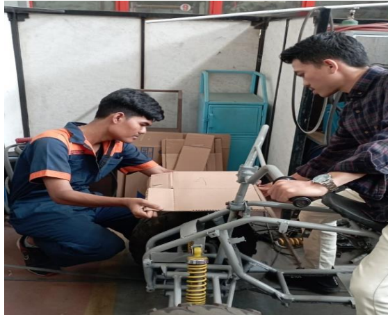
Gambar 14. Pembentukan bodi dengan karton
