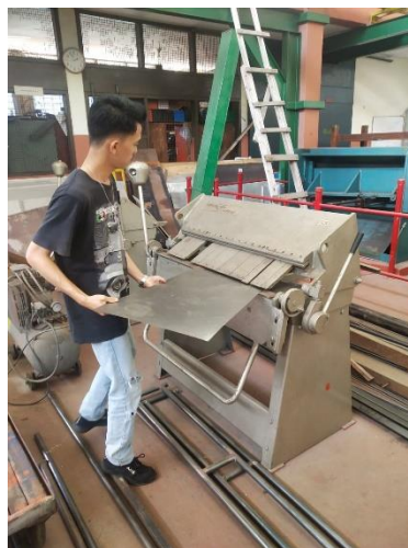
Gambar 15. Pembentukan bodi menggunakan mesin bending
