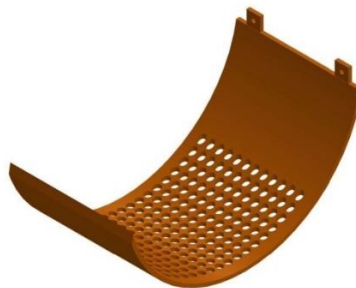
Gambar 10. Saringan (Sumber : Solidworks)
