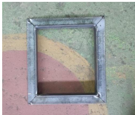
Gambar 17. Tahap Persiapan Sisi Las (Laboratorium Fabrikasi Teknik Mesin FT-UNP)
