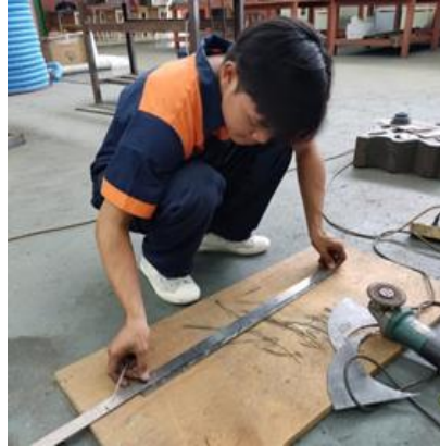
Gambar 22. Pengukuran Besi Siku
