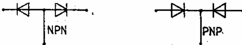
Gambar. Rangkaian pengganti transistor
