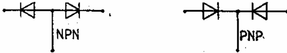
Gambar. Rangkaian pengganti transistor
