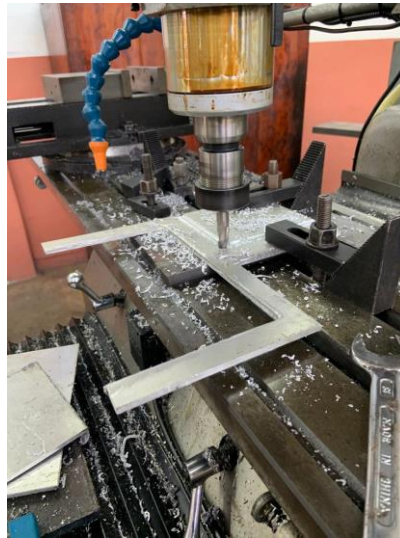
Gambar 4.24 Pembuatan penahan sisi belakang menggunakan T-slot
