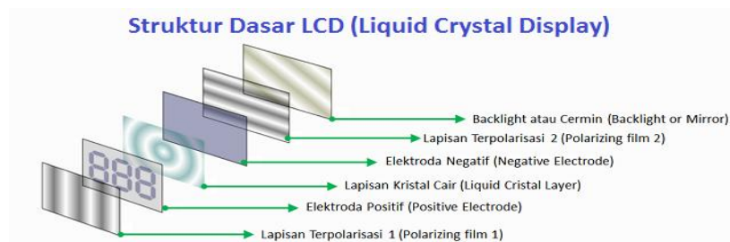
Gambar 9. Struktur Dasar LCD
