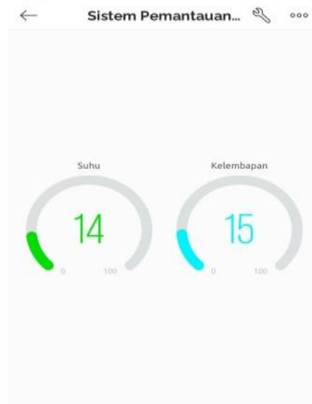
Gambar 17. Tampilan Suhu dan Kelembapan Udara pada Aplikasi Blynk
