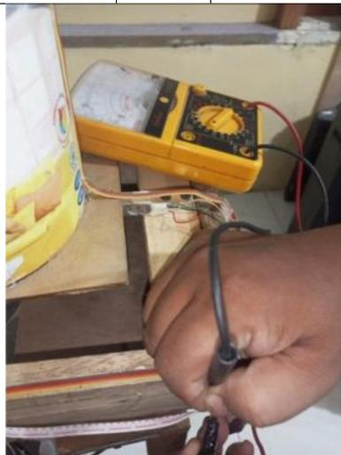
Gambar 25. Pengukuran pada Load Cell
