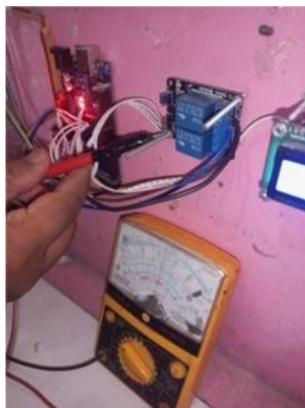
Gambar 29. Pengukuran pada Relay
