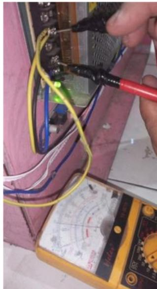
Gambar 20. Pengukurun pada Power Supply
