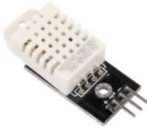
Gambar 5.DHT22 Sensor
