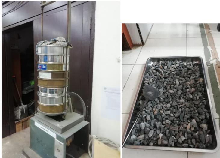
Gambar pengujian analisa ayakan
