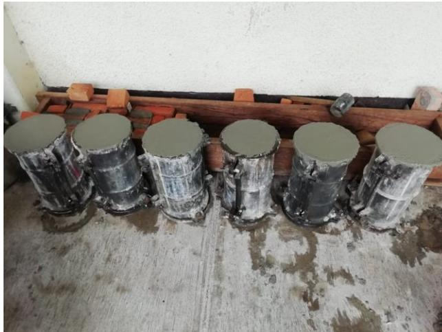
**Gambar 6. Benda Uji Dalam Cetakan**
