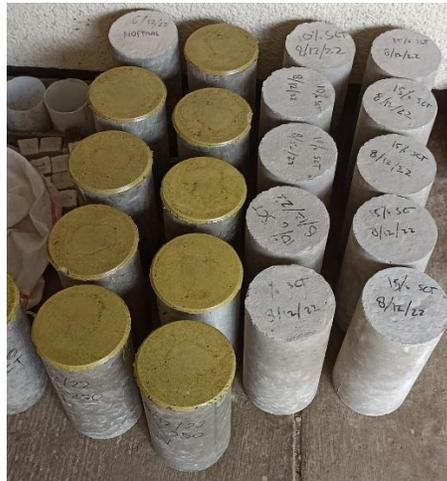
**Gambar 8. Benda Uji Yang Sudah di Capping**
