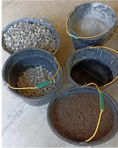
**Gambar 4. Bahan Material Campuran Beton**
