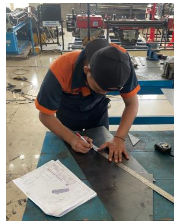
Proses Pengukuran Material Bodi
