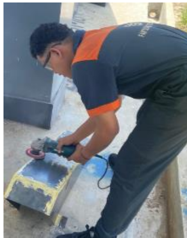
Proses Pengamplasan Hasil Dempul
