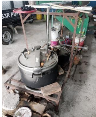
Gambar 1. 3 Alat Pirolisis Yang Sudah Ada
