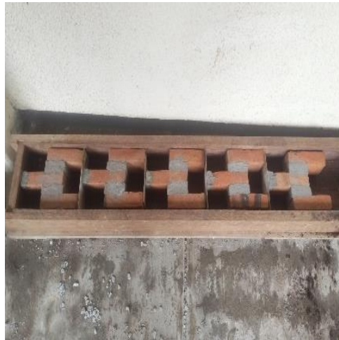
Gambar 4. 16 Benda Uji Geser Dalam Cetakan (Sumber: Dokumentasi Pribadi)
