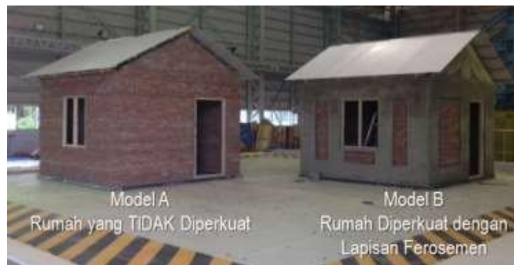
Gambar 2. 5 Dua model struktur yang dibangun di atas meja getar untuk uji coba bangunan tembokan yang diperkuat dengan balutan lapisan ferosemen (Sumber: teddy boen,2019)
