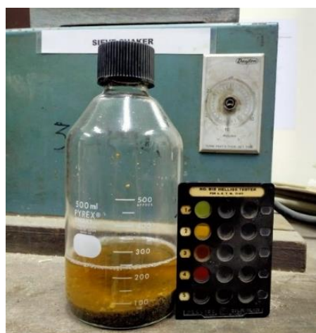
Gambar 4. 1 pengujian zat organik pasir (Sumber: Dokumentasi Pribadi)
