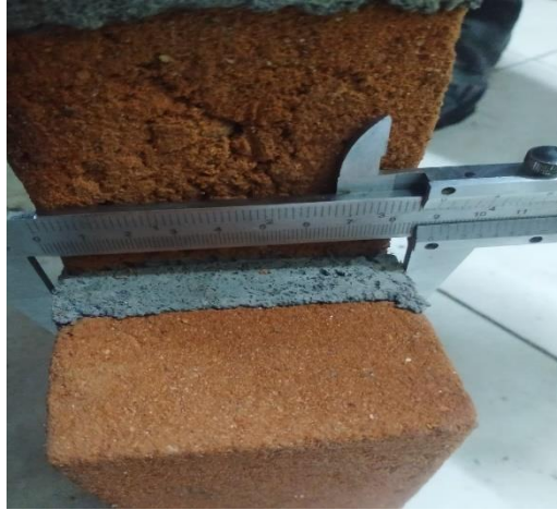
Gambar 4. 18 Pengukuran Sampel Uji Geser (Sumber: Dokumentasi Pribadi)
