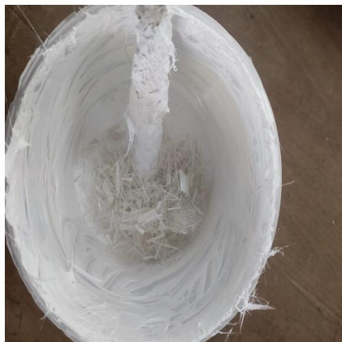
Gambar 4. 7 Pemasukan Serat Kedalam Cat (Sumber: Dokumentasi Pribadi)
