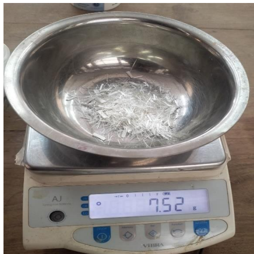
Gambar 4. 6 Penimbangang Serat (Sumber: Dokumentasi Pribadi)
