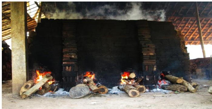
Gambar 2. 11 Proses Pembakaran Bata Merah
