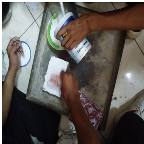
Gambar 4. 10 Pelapisan Cat Serat Pada Sampel (Sumber: Dokumentasi Pribadi)
