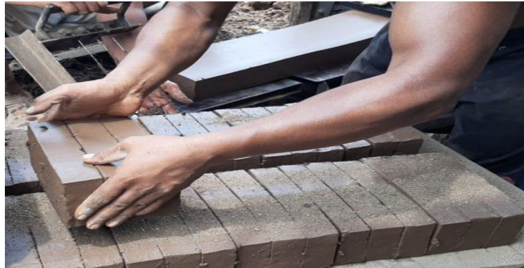
gambar 2. 9 proses pencetakan bata merah sumber: https://www.batubatamerahwelahan.com/blog/proses-pembuatan-batu-bata-merah
