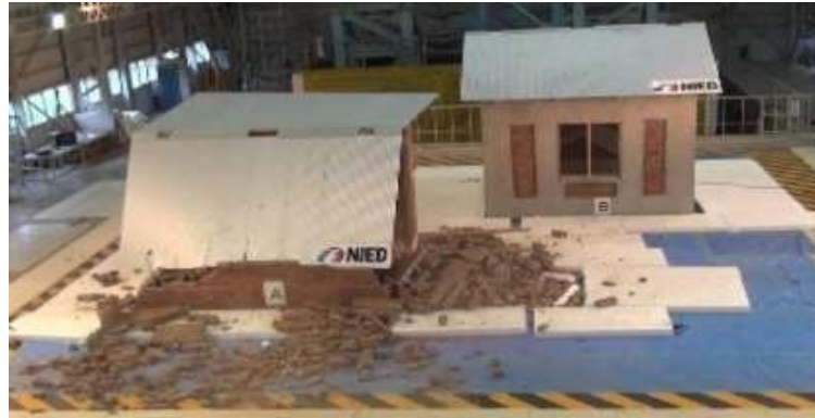
Gambar 2. 6 Akibat Getaran JMA Kobe 2 G: Model A Roboh & Model B Utuh (Sumber: teddy boen,2019)
