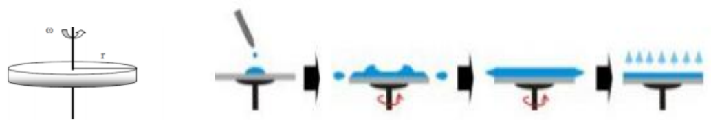
Gambar 4. (a) Piringan Berputar dan (b) Skema Tahapan spin coating
