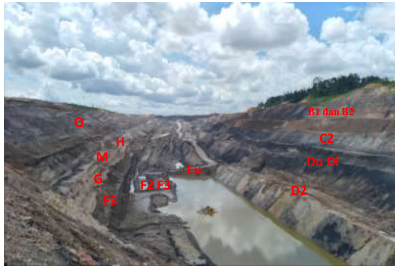
Gambar 5. Lapisan multyseam pada PIT 7 West PT. Bukit Makmur Mandiri Utama Jobsite Binungan Suaran.
