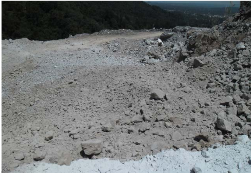
Gambar 21. Lemparan Batuan Hasil Peledakan dengan Geometri Usulan II
