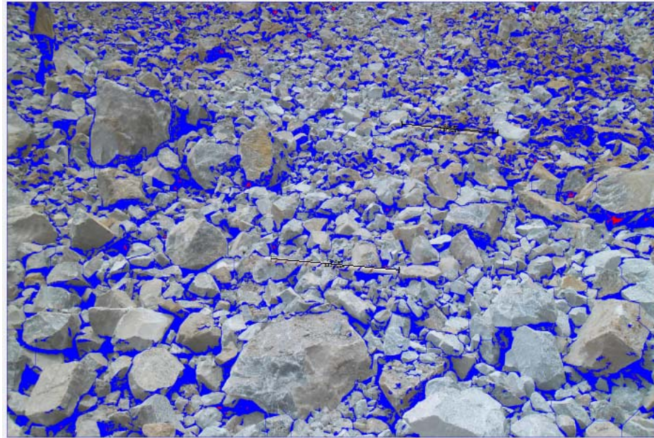
Gambar 17. Hasil Pengukuran Fragmentasi Usulan II Percobaan 4 Menggunakan Split Desktop
