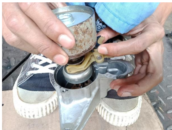
Gambar 42. Pemasangan Drive Lever dan Starter Clutch dengan Peredam Kejut
