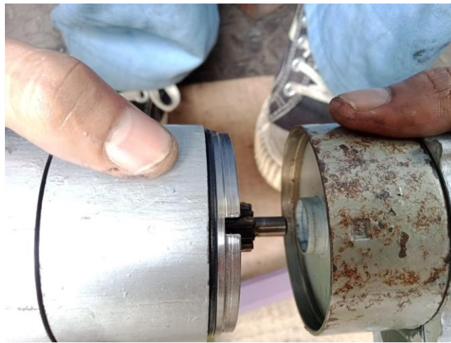
Gambar 46. Pemasangan Field Frame dan Rakitan Armature
