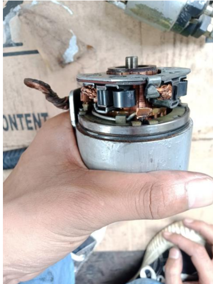
Gambar 44. Pemasangan Pemegang Brush
