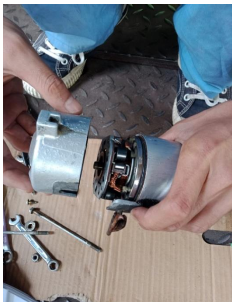
Gambar 45. Pemasangan Frame Ujung Komutator
