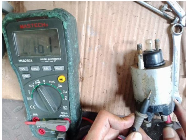
Gambar 37. Periksa Open Sirkuit pada Hold In Coil
