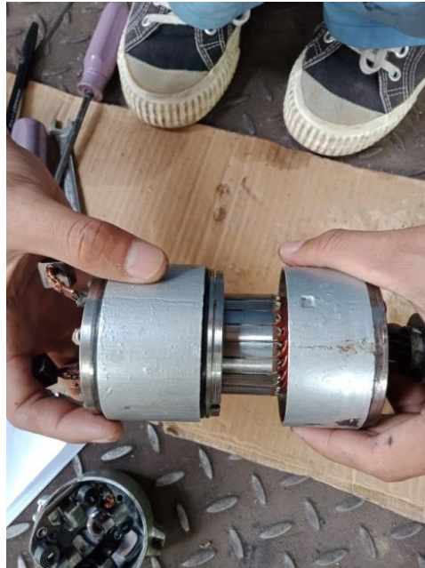
Gambar 43. Pemasangan Armature pada Field Frame
