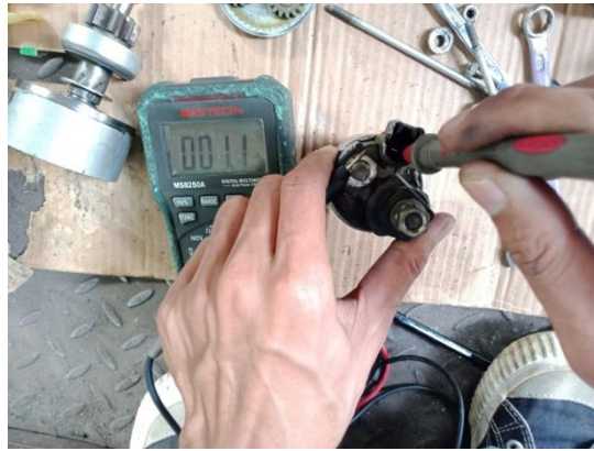
Gambar 36. Periksa Open Sirkuit pada Pull In Coil
