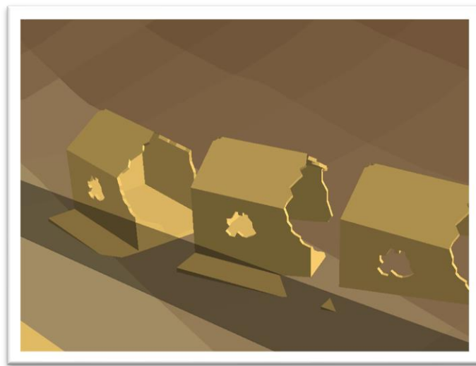
Gambar 14 : Tingkat Kerusakan Level 4
