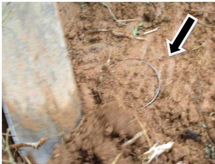
Gambar 14. Pengambilan Sampel menggunakan Ring Sampel untuk Uji Permeabilitas
