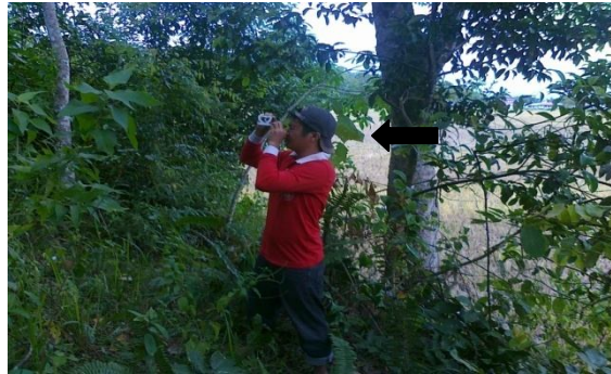
Gambar 11. Foto Pengukuran Kemiringan Lereng di Lapangan Menggunakan Abney Level . (Dokumentasi Pribadi, 2012).
