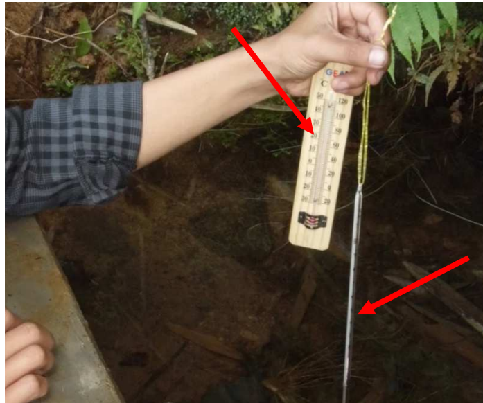
Gambar V.3. Pengukuran Suhu Mataair Dalam Gadiang dan Udara di Sekitarnya, Hasil Pengukuran Menunjukkan Suhu Mataair 23^{\circ}\text{C} dan Suhu Udara di Sekitarnya 27^{\circ}\text{C} . (Sumber: Dokumentasi Pribadi, Juni 2010)
