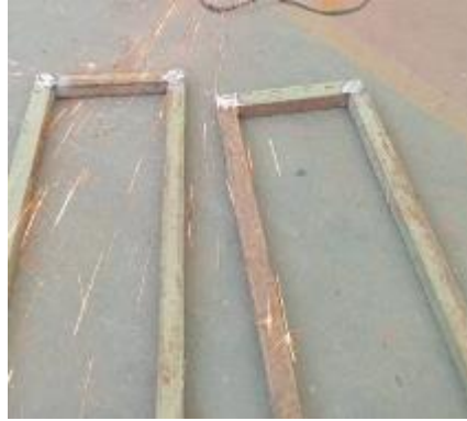
Gambar 4.7 Pemeriksaan Rangka Setelah Pengelasan
