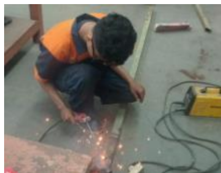
Gambar 4.6 Proses Pengelasan Rangka Tangga
