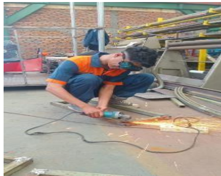
Gambar 4.8 Proses Pembersihan Terak Las
