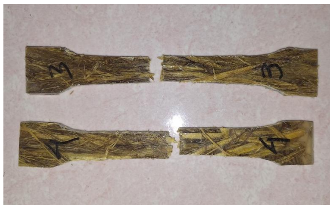
Gambar 4. 13 : Patahan Spesimen Susunan Vertikal/Horizontal
