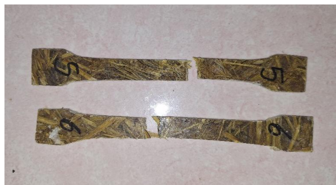
Gambar 4. 14 : Patahan Spesimen susunan Serat Acak
