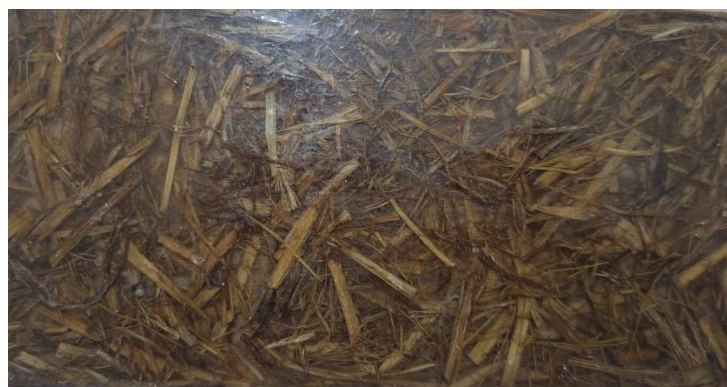
Gambar 4.2 : Papan Komposit Setelah dicetak
