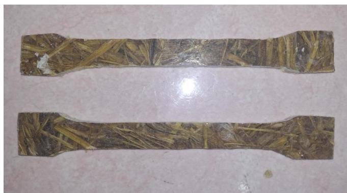
Gambar 4. 5 : Spesimen Susunan Serat Acak
