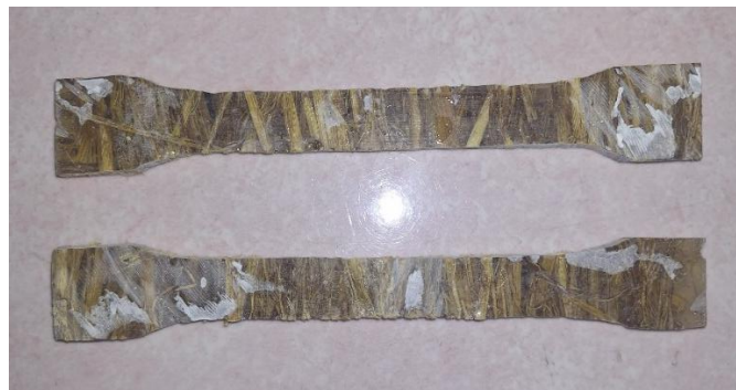
Gambar 4. 4: Spesimen Susunan Serat Vertikal/Horizontal
