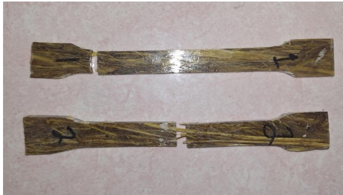
Gambar 4. 12 : Patahan Spesimen Susunan serat Vertikal
