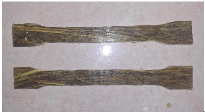
Gambar 4. 3 : Spesimen Susunan Serat Vertikal
