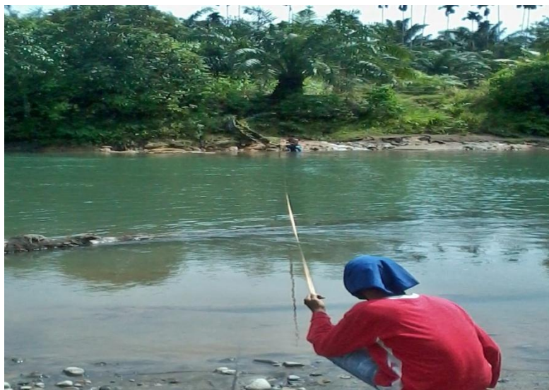
Gambar 9. Mengukur Kecepatan Aliran Sungai
