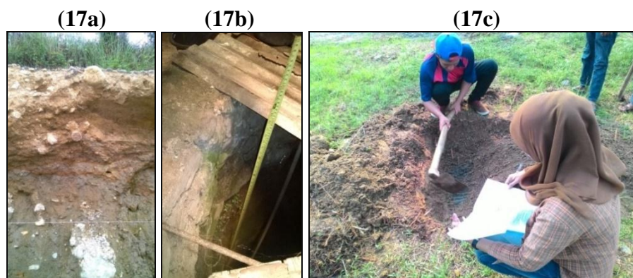
Gambar 17. Pengukuran Kedalaman Hamparan Batuan Dasar
