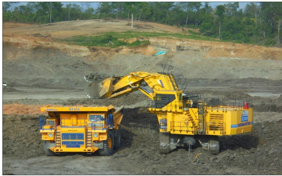
Gambar 10. Penggalian dan Pemuatan Overburden
