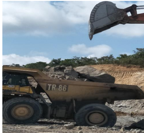
Gambar 1 loading Excavator Hitachi PC 2500 pada bongkahan batuan
