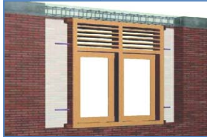
Gambar 7: Balok Pinggang di atas pintu dan jendela Sumber : Teddy Boen (2005).
