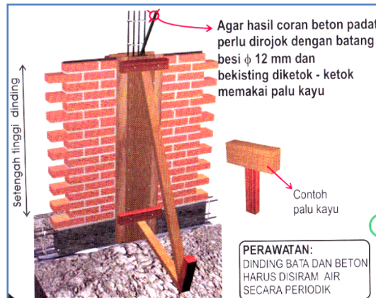
Gambar 5: Proses Pengecoran Kolom.
