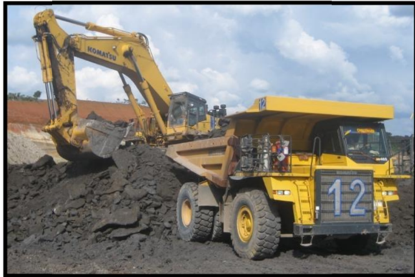
Gambar 8. Komatsu HD 465 Kapasitas 65 Ton
