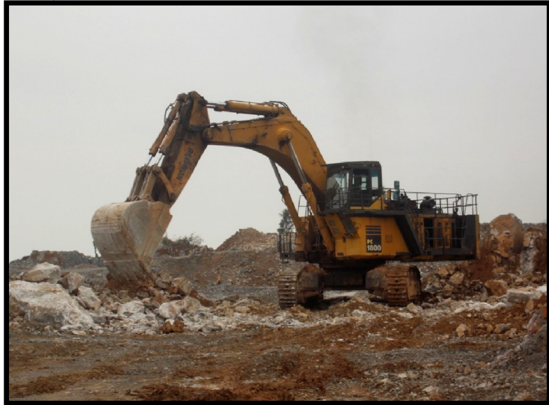
Gambar 10. Excavator Jenis Back Hoe
