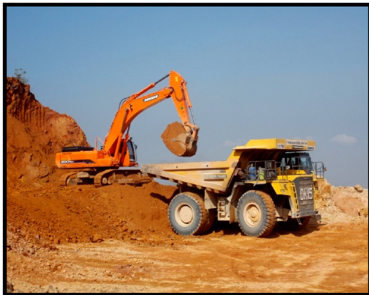
Gambar 13. Pola Pemuatan Top Loading
