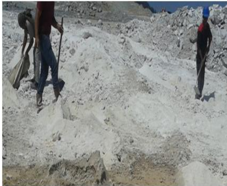
Gambar 22. Proses memasukkan ANFO dan stemming
