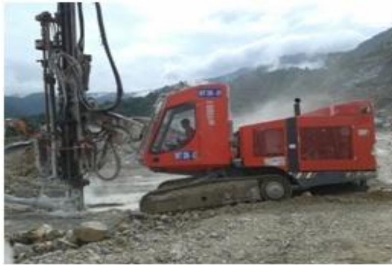
Gambar 9. Alat Bor Sandvik DP 1100 DM 05
