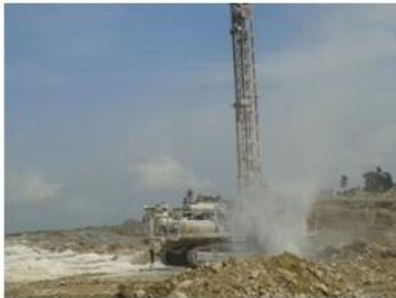
Gambar 9. Alat Bor Sandvik DP 1100 DM 05
