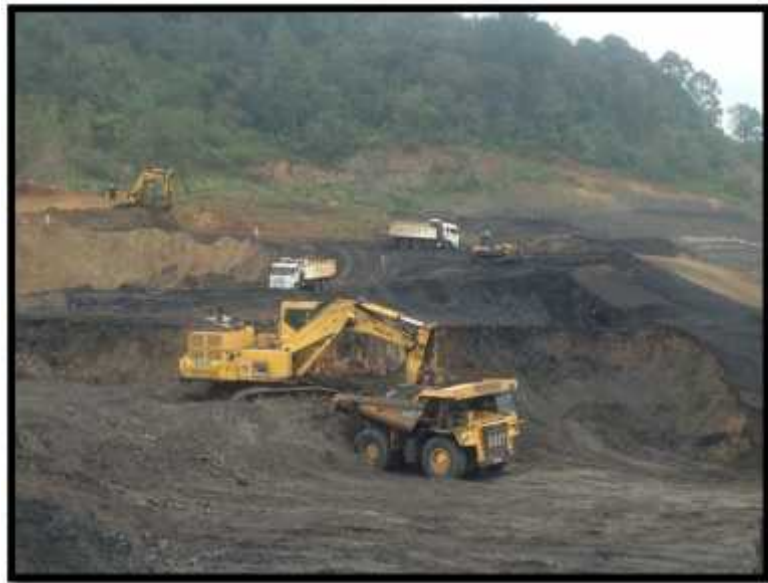
Gambar 6. Pola Pemuatan Top Loading
