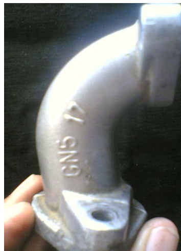
Gambar 3. Intake Manifold Standar Sepeda Motor Honda Supra X. (Dokumentasi: 27 Juni 2010)
