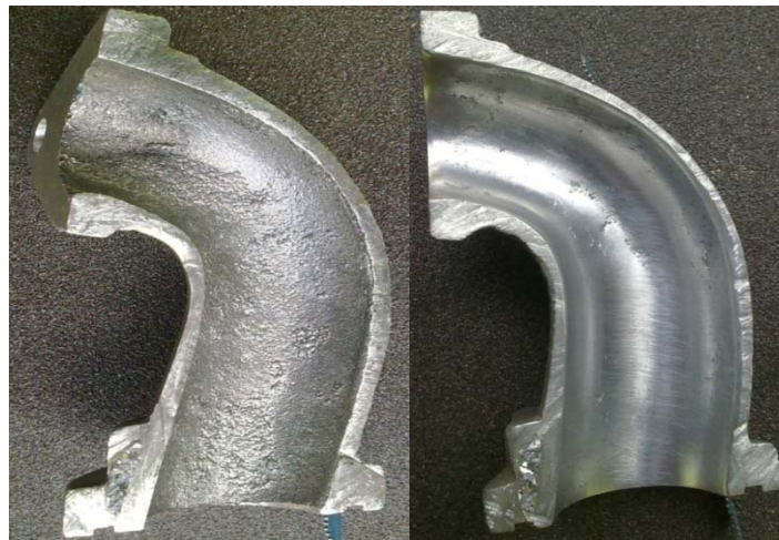
Gambar 4. Perbedaan Intake Manifold standar dengan Modifikasi (Dokumentasi: 17 Agustus 2010)
