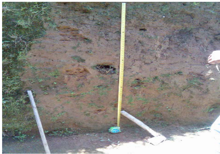
Gambar 5.6 : Foto Pengukuran tebal solum tanah di satuan lahan
