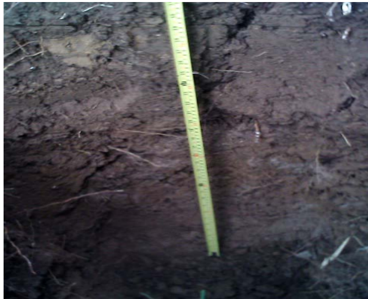
Gambar 5.2 : Foto pengukuran tebal solum tanah pada satuan lahan
