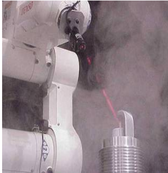
Gambar 7. Pembuatan busi iridium dengan bantuan laser ( http://triatmono.wordpress.com )
