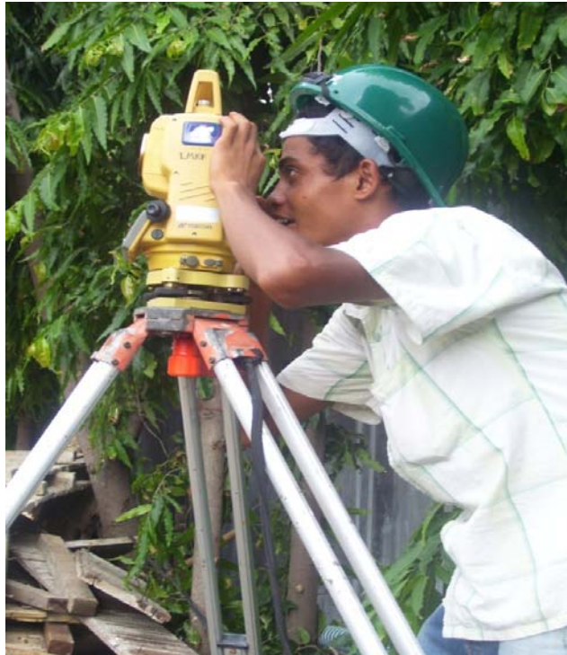
Gambar 13 : Pengecekan Titik Elevasi Menggunakan Alat Stasioner Sumber: Dokumentasi Praktek Lapangan Industri
