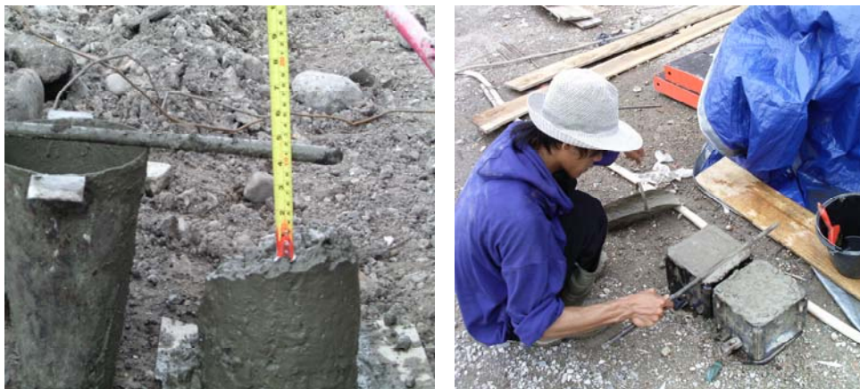
Gambar 16: Uji slump dan Pembuatan Benda Uji Sumber: Dokumentasi Praktek Lapangan Industri
