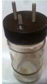
Gambar 8. Tabung elektrolisis air
