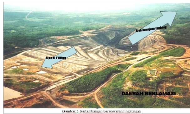
Gambar 5 : Metode Back filling
