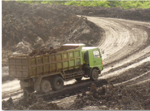
Gambar 9 : Pengangkutan Overburden menggunakan DT. Hino Superranger
