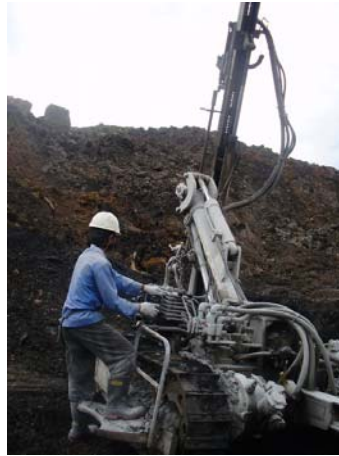
Gambar11 : Pemboran dengan alat bor furukawa Rock drill
