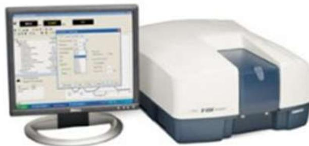
**Gambar 2. 7** Spektrofotometer UV-Vis
