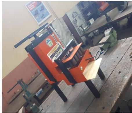
**Gambar 2. Alat cetak getah gambir sistem impact**
