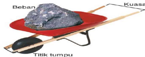
Gambar :(Gerobak Dorong) Tuas golongan kedua Sumber: Rositawaty (2008:84)
