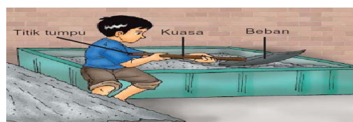
Gambar: (Sekop) Tuas golongan ketiga Sumber: Rositawaty(2008:85)
