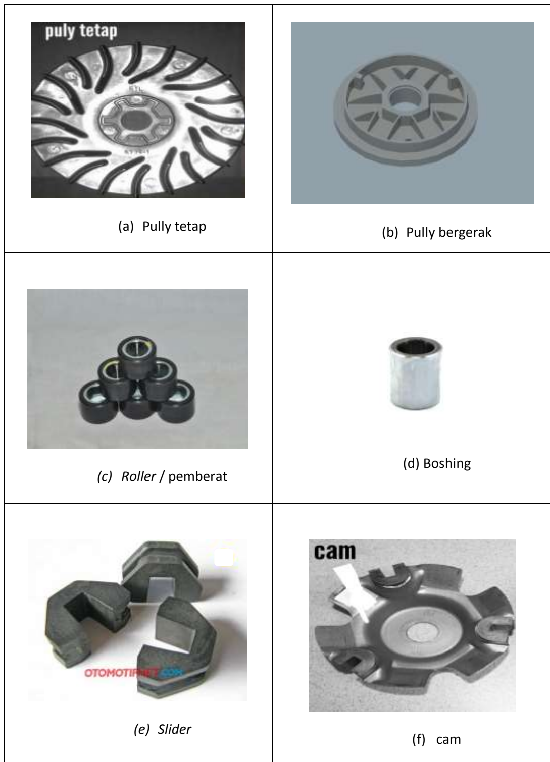
Gambar 4. Komponen pada primary sheave , a) Pully tetap b) pull bergerak c) roller d) boshing e) slider f) cam.
