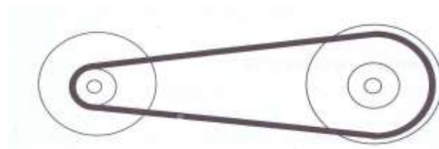
Gambar 1. Posisi V-belt saat mulai berjalan (Sumber : Yamin, Dkk, 2009 : 4)
