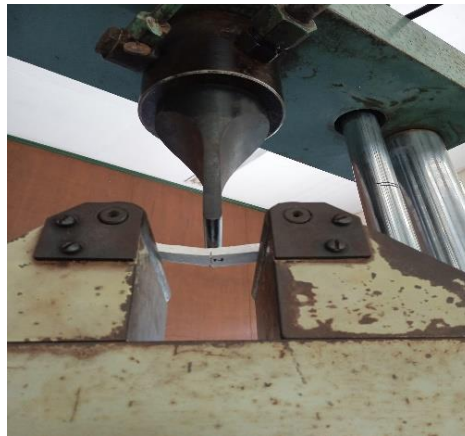
Gambar 19. Pengujian kuat lentur (Sumber: Dokumentasi pribadi)
